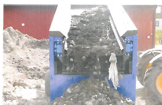
3 stocks matériau mètres de haut, sur un 1,2 mètre transporteur large
